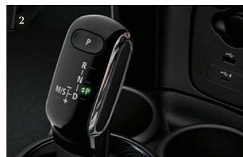
① MINI Driving Modes. ② Selettore del cambio elettronico per il cambio a doppia frizione a 7 rapporti.
